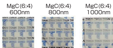
ガラス基板上に成膜したMg(OH) 2 -C透明導電膜
