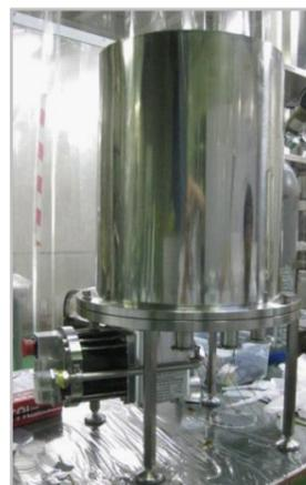
冷凍機冷却型超電導電磁石の外観
